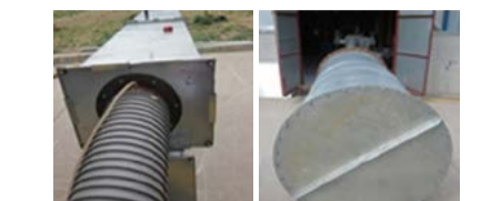
图 3 风管的强度试验
